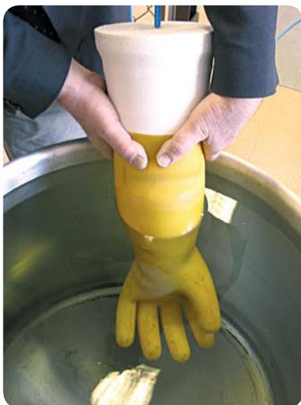
Fot. 3. Próba szczelności Photo 3. Tightness trial
