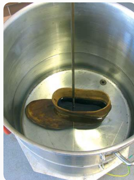
Fot. 5. Badanie elektryczne obuwia elektroizolacyjnego Photo 5. Electricity trial of an insulating footwear
