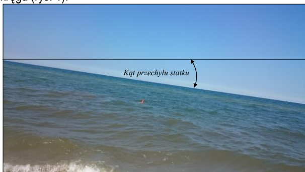
Rys. 1. Obraz linii widnokregu obserwowany kamerą na przechylnym statku
