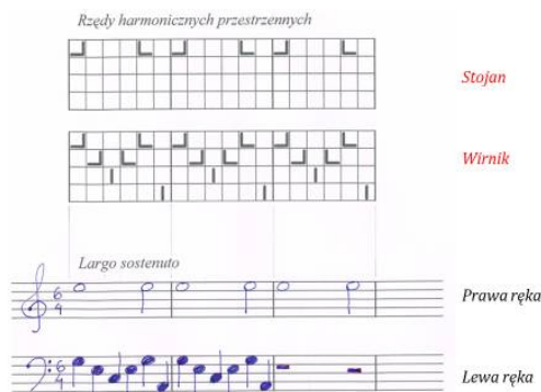
Rys. 49. Fortepianowa notacja muzyczna dla prawej i lewej ręki oraz diagramy rozkładu poliharmonicznej maszyny 6-fazowej na elementarne maszyny dwufazowe i jednofazowe
