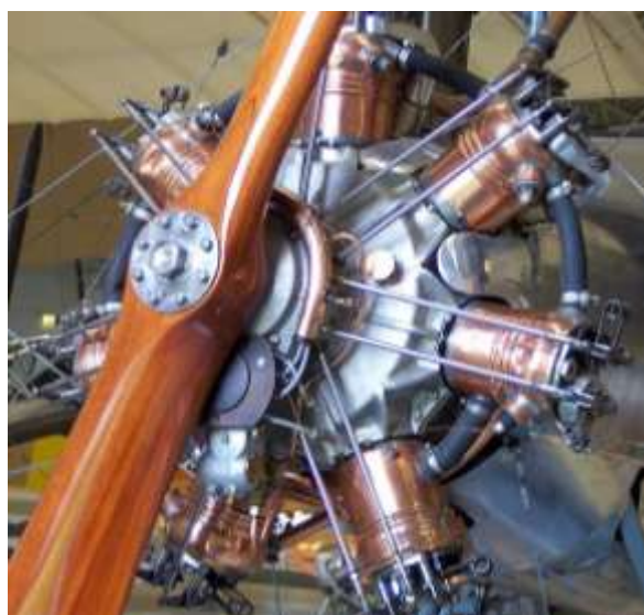
Rys. 2. Silnik gwiazdowy Salmson 9 [2]
