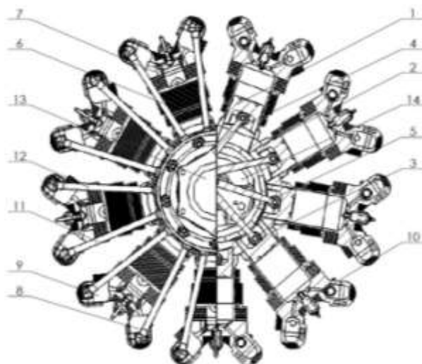
Rys. 3. Budowa silnika gwiazdowego: 1 - tłok, 2 - pierścień tłokowy, 3 - sworzeń tłokowy, 4 - korbowód, 5 - wał korbowy, 6 - cylinder, 7 - głowica, 8 - pokrywa głowicy - kanał dolotowy, 9 - pokrywa głowicy - kanał wylotowy, 10 - świeca zapłonowa, 11 - popychacz zaworu wydechowego, 12 - popychacz zaworu dolotowego, 13 - pokrywa tylna silnika, 14 - pokrywa przednia silnika. Źródło: opracowanie własne
