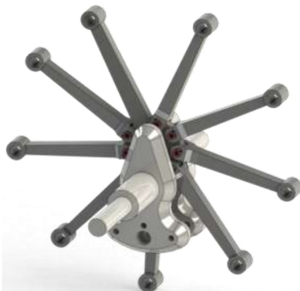
Rys. 5. Układ: wał korbowy połączony z korbowodem głównym i z korbowodami przyczepnymi. Źródło: Opracowanie własne.
