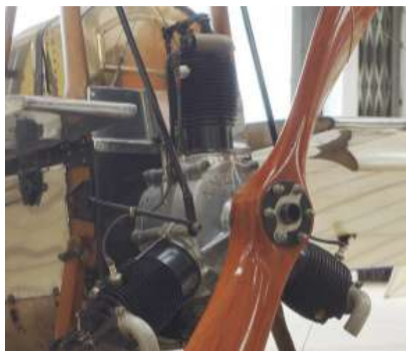
Rys. 1. Trzycylindrowego silnik gwiazdowy [1]
