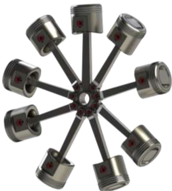
Rys. 6. Gwiazdowy układ korbowo - tłokowy Źródło: opracowanie własne
