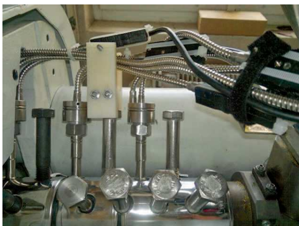
Rys. 3. Czujniki pT umieszczone w cylindrze wtryskarki
