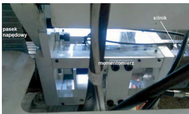
Rys. 4. Momentomierz wbudowany w układzie napędowym wtryskarki
