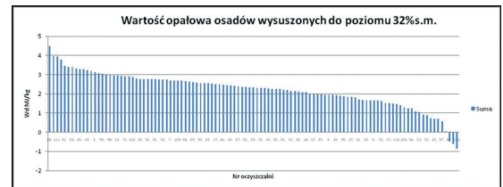
Rys. 9 Wartość opałową osadów ściekowych województwa śląskiego wysuszonych do poziomu 32% s.m.
