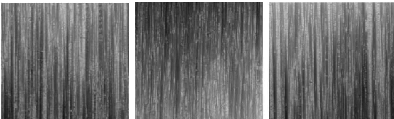
Rys. 2. Obrazy SGP w zależności od sposobu chłodzenia i smarowania w czasie obróbki: a) E – z udziałem emulsji, b) MQL, c) S – na sucho
