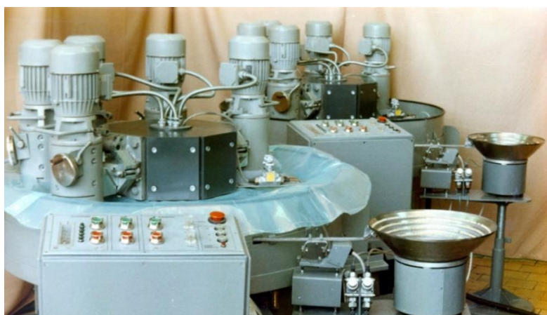
Rys.1. Szlifierka do automatycznej obróbki elementów ceramicznych Fig. 1. The grinder to automatic processing of the ceramic elements
