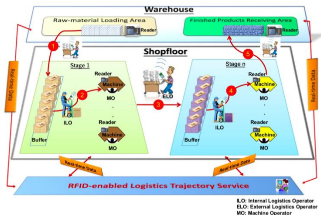
Rys. 2 Zastosowanie technologii RFID w czasie rzeczywistym w zakładach produkcyjnych.
