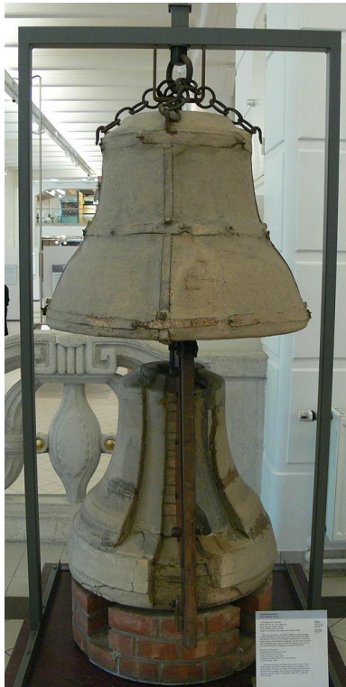
Rys. 1. „TMW - Glockenguss” by Wolfgang Sauber, forma odlewnicza dzwonu jako eksponat w Wiedeńskim Muzeum Techniki
