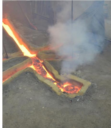
Rys. 2. Zalewanie formy „narodziny dzwonu”, widoczne gazy wydobywające się z formy przez otwory w formie korony (fot. Pracownia Ludwisarska Jan Felczyński, http://www.janfelczynski.com/ )
