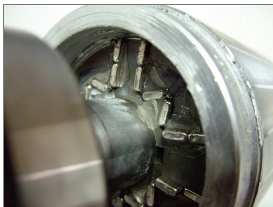
Rys. 1. Wirnik nr 1 – rozmieszczenie magnesów w układzie W
