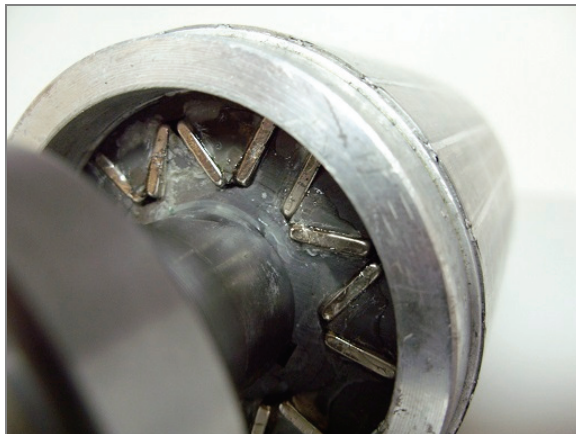
Rys. 2. Wirnik nr 2 – rozmieszczenie magnesów w układzie VV
