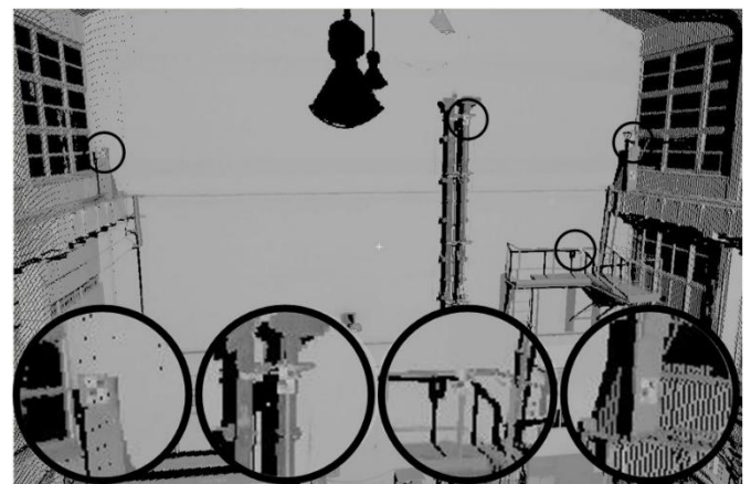
Rys. 11. Fragment trójwymiarowego modelu odwzorowania hali technologicznej z widocznymi markerami
