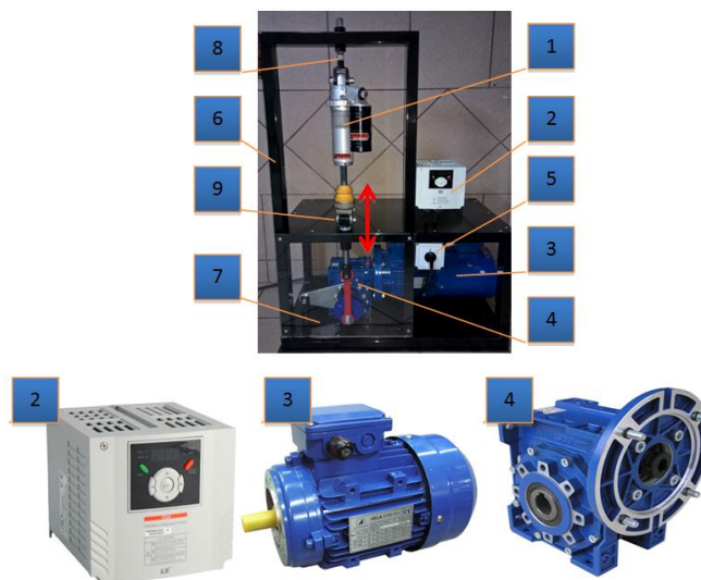
Rys. 2. Część elektromechaniczna stanowiska: 1 – amortyzator wraz ze sprężyną gazową, 2 – falownik, 3 – silnik, 4 – przekładnia-reduktor wraz układem mimośrodowym, 5 - włącznik zasilania, 6 – stalowa rama z podstawą, 7 – osłona z pleksi, 8 – miejsce mocowania czujnika siły, 9 – miejsce pomiaru prędkości ruchu.
