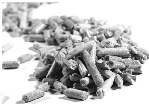
Rys. 4.1. Pelety drzewne. Parametry techniczne peletu: wilgotność 10%, popiół, 0,7%, wartość opałowa 18,5 MJ/kg
