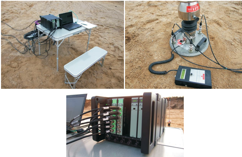
Rys. 2. Układ pomiarowy firmy Brüel & Kjær i lekka płyta dynamiczna typu ZFG-01
