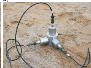
Rys. 1. Podstawy pomiarowe wykorzystane w badaniach terenowych: a) widok ogólny rozmieszczenia podstaw; b) podstawa pierścieniowa; c) podstawa krzyżakowa z głowicą aluminiową; d) podstawa w formie pojedynczego pręta z głowicą aluminiową
