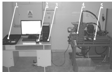
Rys. 2. Stanowisko do badania i analizy wyników procesu brykietowania biomasy: 1 - zestaw oprzyrządowania i części dodatkowych firmy Parker, 2 - przyrząd pomiarowy Serviceman Plus ® , 3 - stanowisko komputerowe wraz z oprogramowaniem SensoWin, 4 - czujnik SCT-150-04-02 służący do pomiaru temperatury; 5 - brykierciarka APT 35 [Mroziński, 2014]
