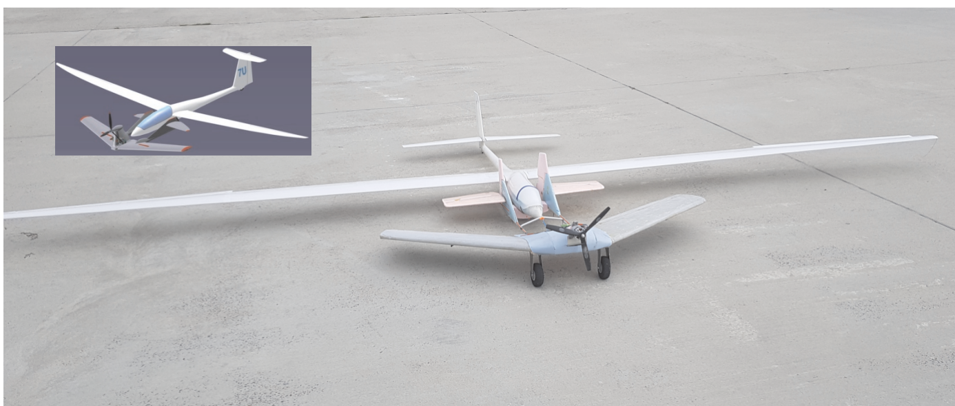
Rys. 10. Model zespołu szybowiec i BSP-holownika – wersja 2 z obniżoną wieżyczką silnika i podwoziem z tylnym punktem podparcia
