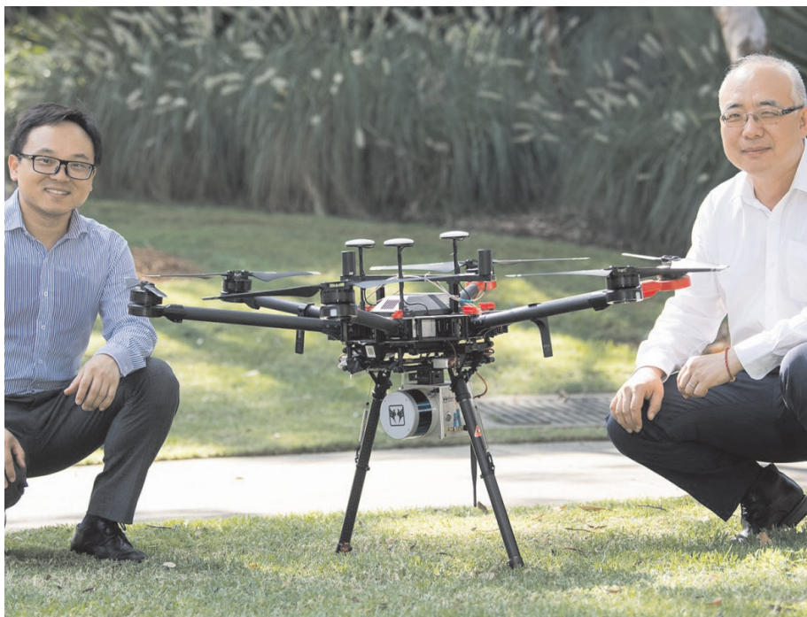
Rys. 2. Dron do wykrywania i monitorowania pożarów lasów w Australii, DJI Matrice 600 Pro [23]
