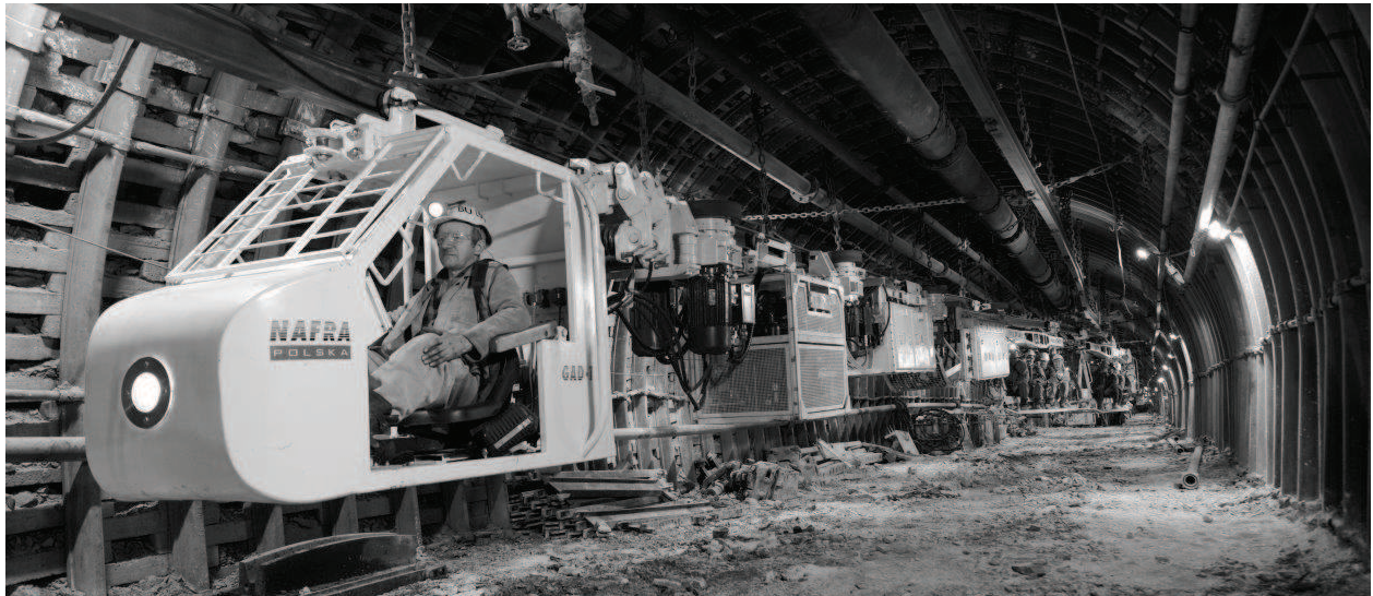
Rys. 1. Ciągnik GAD-1 pracujący w wyrobisku korytarzowym [8]
