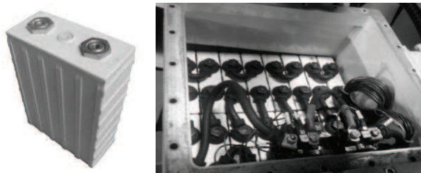
Rys. 7. Widok pojedynczego ogniwa oraz całej baterii zastosowanej w ciągniku PCA - 1 [3]
