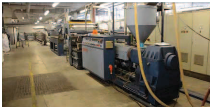
Rys. 1. Schemat linii do produkcji tasiemek PP Starlinger STAREX 1000 90/30 D [20, 21]
