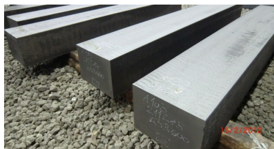
Rys. 8. Kucie pręta o przekroju kwadratowym na kowarce SMX 800/18 MN w Vitkovicie – Czechy (a) i wykonane odkuwki (b) [6] Fig 8. The square bar forged on SMX machine in Vitkovice, Czechia (a) and final forgings (b) [6]
