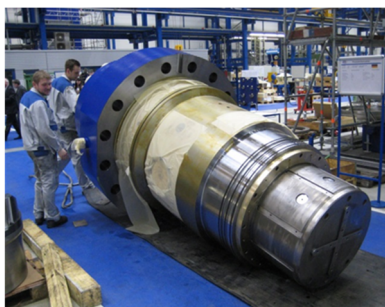
Rys. 4. Tłok roboczy kowarki SMX/22 MN [4]
