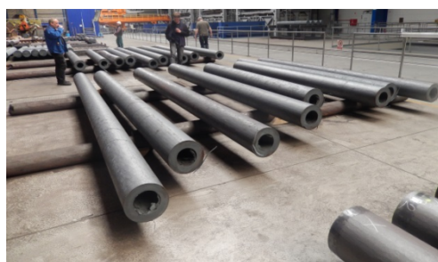
Rys. 9. Wyroby kute na kowarce SMX : a – podwójnie kute osie kolejowe, b – rury grubościenne [4] Fig. 9. SMX products: a – dual forged rail axles, b – thick-walled tubes [4]
