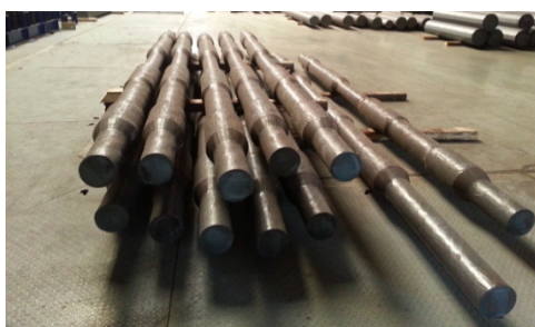
Rys. 9. Wyroby kute na kowarce SMX : a – podwójnie kute osie kolejowe, b – rury grubościenne [4] Fig. 9. SMX products: a – dual forged rail axles, b – thick-walled tubes [4]
