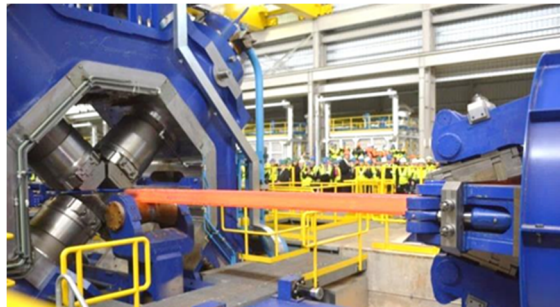
Rys. 6. Kucie pierwszej odkuwki w postaci pręta na kowarce SMX 1100/22MN [4]
