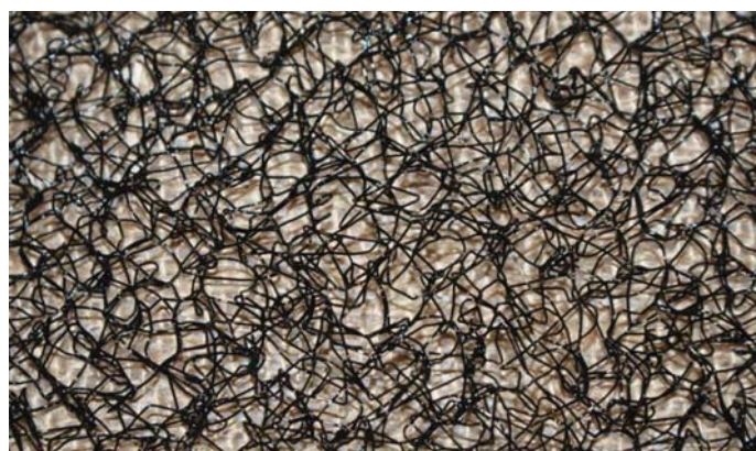
Fot. 1. Polimerowa geomata przeciwoerozyjna połączona z tkaniną jutową (fot. Beata Gajewska) – wyrób budowlany wprowadzony do obrotu na podstawie Aprobataj Technicznej IBDiM
