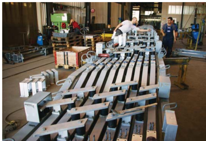
Fot. 4. Wielomodułowe urządzenie dylatacyjne podczas produkcji (fot. A. Niemierko) – wyrób budowlany wprowadzony do obrotu na podstawie Aprobaty Technicznej IBDiM
