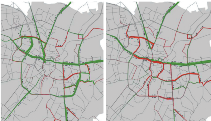
Rys. 5. Zmiany potoków (pas./godz.) w sieci autobusowej (po lewej) oraz w sieci tramwajowej (po prawej) w wyniku zastosowania funkcji zatłoczenia sieci – Rzeszów, model tramwajowy z redukcją linii autobusowych
