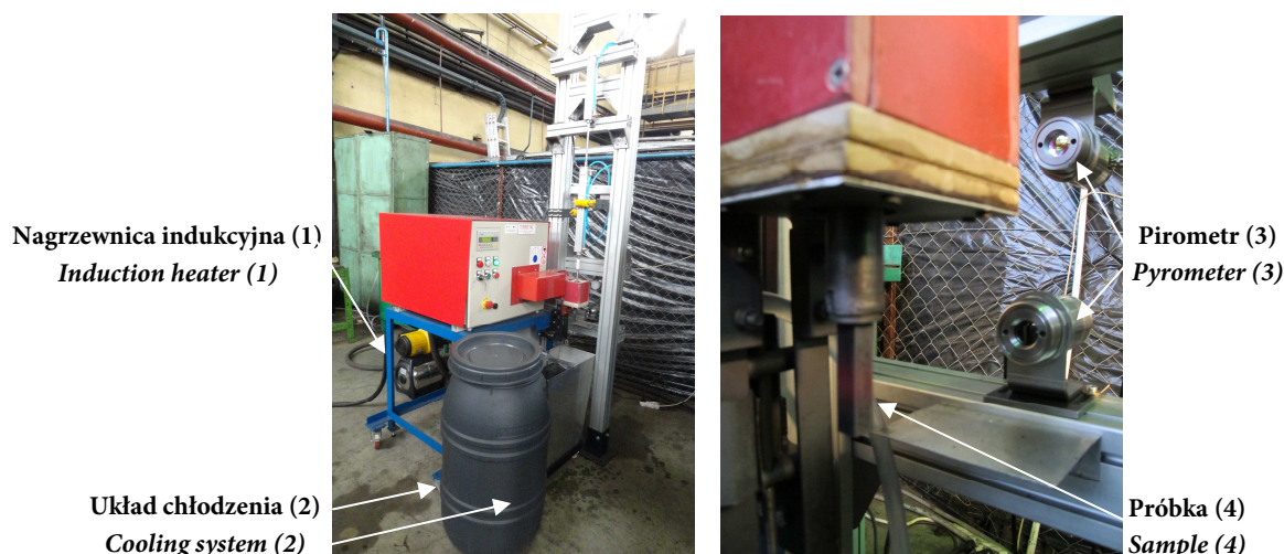
Rys. 1. Stanowisko do badań zmęczenia cieplnego
