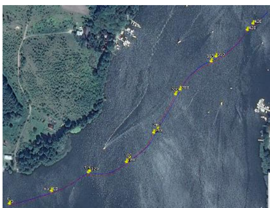
Rys. 7. Droga wzorcowa (linia czerwona) i droga wyznaczona metodą zliczania (linia niebieska)
