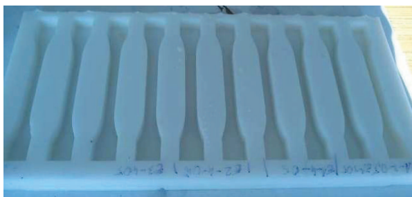
Rys. 2. Forma silikonowa zastosowana do tworzenia próbek kompozycji klejowych
