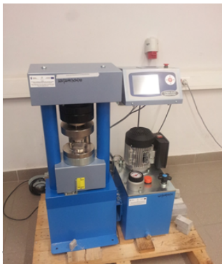
Rys. 1. Maszyna wytrzymałościowa wykorzystana do badania wytrzymałości na ściskanie zapraw.
