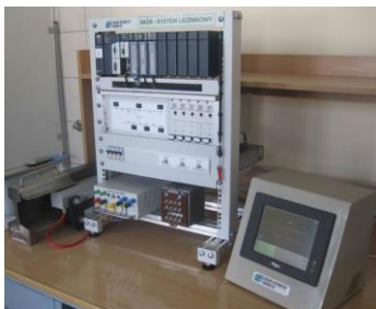
Rys. 4 Rozmieszczenie elementów i widok stanowiska badawczego systemu licznikowego typu SKZR w Laboratorium Systemów SRK w UTH Radom
