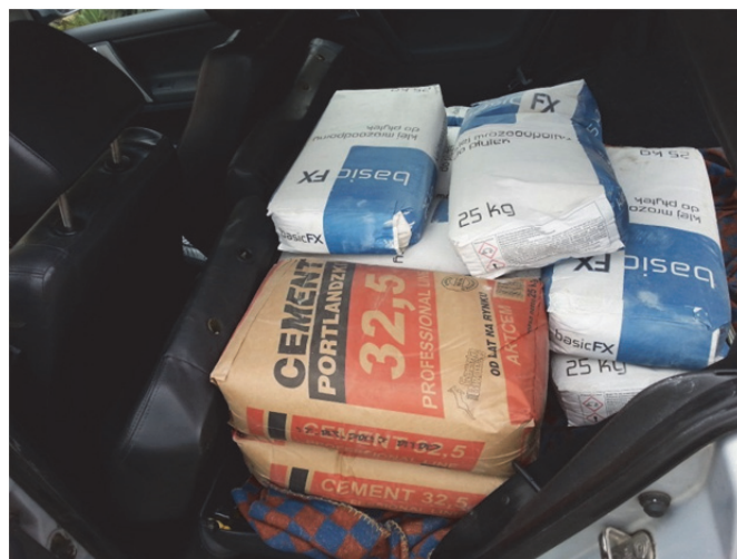
Rys. 6. Sposób rozmieszczenia dodatkowego obciążenia wewnątrz pojazdu
