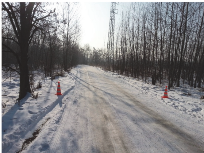
Rys. 4. Sposób oznaczenia początku hamowania
