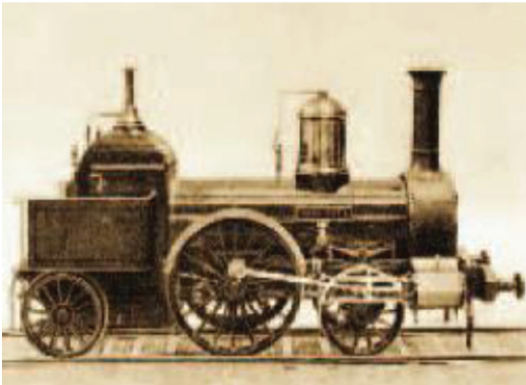
Rys. 12. Parowóz osobowy o układzie osi 1A1 „OBERHAUSEN” (nr fabr. 136), produkcji zakładów Borsiga z 1847 r. dla Cöln-Mindener Eisenbahn-Gesellschaft (CME). Fotografia wykonana w 1850 r. Najprawdopodobniej taki wygląd mogły mieć parowozy o numerach I–IV (późniejsze „KRAKÓW”, „OŚWIĘCIM”, „LEMBERG” i „TARNÓW”), które zostały wyprodukowane dla Krakau–Oberschlesische Eisenbahn (OSE)
