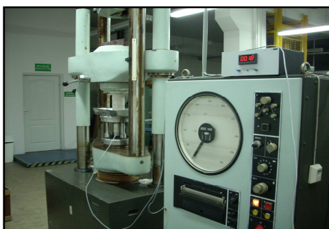
Rys. 5. Widok maszyny hydraulicznej EDZ – 100 przystosowanej do badania wytrzymałości na ściskanie [12]
