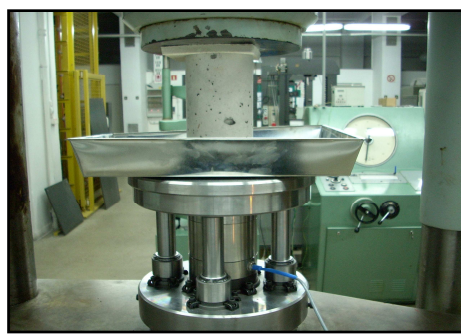
Rys. 6. Widok próbki betonowej przygotowanej do badania wytrzymałości [12]
