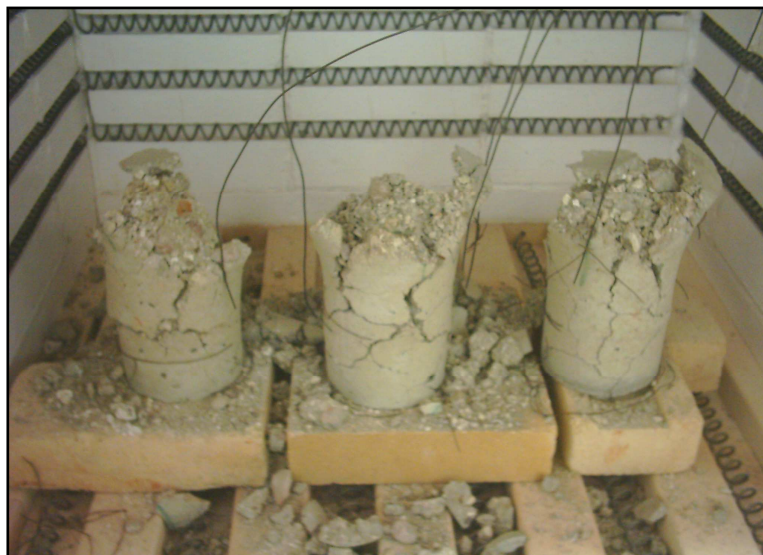
Rys. 10. Widok próbek z betonu klasy C30/37 po badaniu w temperaturze 1000 °C [12]
