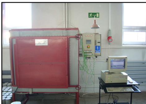
Rys. 3. Widok pieca komorowego PK 1100/5 z oprzyrządowaniem [12]
