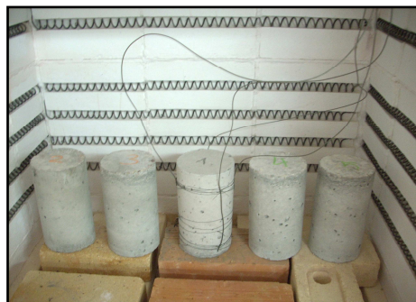
Rys. 4. Widok próbek betonowych przygotowanych do wygrzewania z zamontowanymi termoparami pomiarowymi [12]
