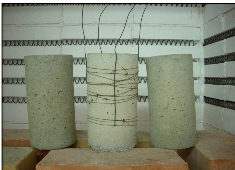
Rys. 11. Widok próbek z betonu klasy C60/75 po badaniu w temperaturze 1000 °C [13]
