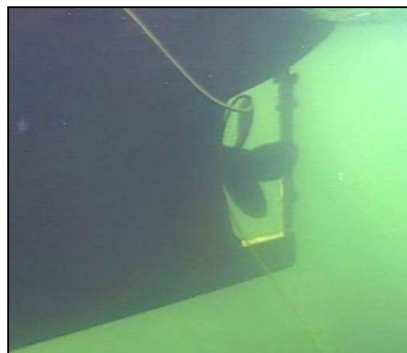
Rys. 7. Kablołina pojazdu KRAB zapląkana w oknie śrubowym statku-bazy w trakcie badań poszukiwawczych wraków w okolicy Kołobrzegu.
