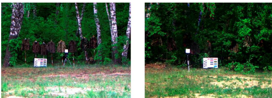
Rys. 8. Scena przedstawiające 8 mundurów ustawionych w dwóch warunkach oświetleniowych. Obrazy w barwach naturalnych: R – kanał 24 (660 nm), G – kanał 15 (560 nm), B – kanał 3 (440 nm)
