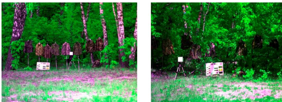
Rys. 10. Kompozycje barwne. R – kanał 5 (690 nm), G – kanał 8 (720 nm), B – kanał 2 (660 nm)
