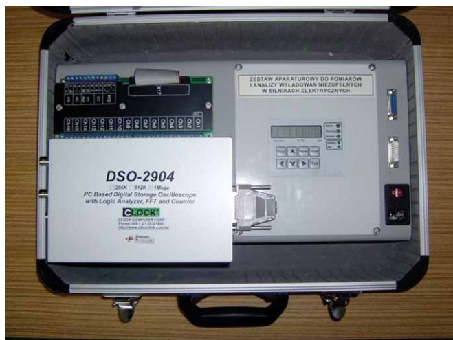
Rys. 16. Przenośny zestaw aparaturowy do pomiarów wnz silników [24, 25]
