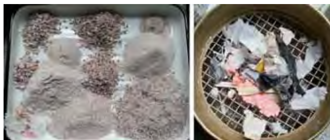
Rys. 9. Poszczególne klasy ziarnowe oraz odseparowane zanieczyszczenia po próbach rozdrabniania soli w kruszarce KWBd.
