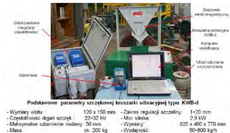
Rys. 6. Widok stanowiska laboratoryjnego wibracyjnej kruszarki szczękowej KWbD o bezwładnościowym wymuszeniu ruchu drgającego szczęk oraz jej podstawowe parametry.
