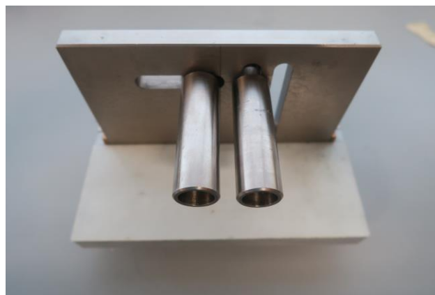
Rys. 3. Oprzyrządowanie do badania wytrzymałości siły odrywania
