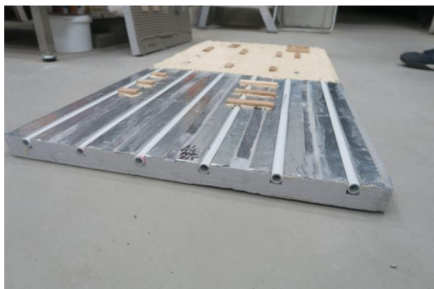
Rys. 14. Płyta grzejna wykonana na bazie XPS „wafel” z wklejonymi lamelami aluminiowymi, pokryta w całości lub punktowo klejem Sika Bond T8 z próbkami drewna
