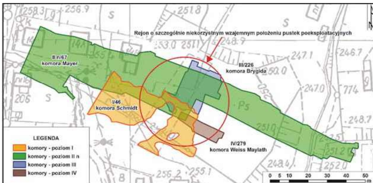
Rys. 6. Rozmieszczenie komór o niekorzystnym wzajemnym układzie wyrobisk w płaszczyźnie pionowej Fig. 6. Mining chambers with unfavorable vertical distribution
