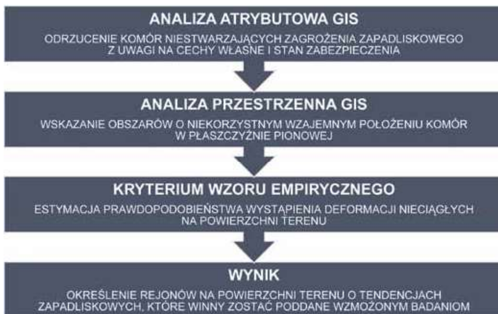
Rys. 5. Schemat algorytmu identyfikacji obszarów stwarzających ryzyko zapadliskowe Fig. 5. Scheme of an algorithm to identify zones with a threat of sinkhole
