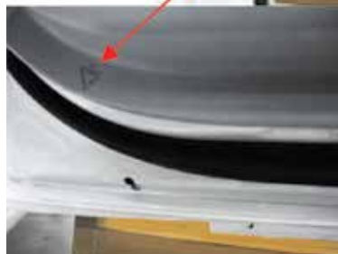
Fot. 2. Usuwanie uszczelki drzwi [3]
