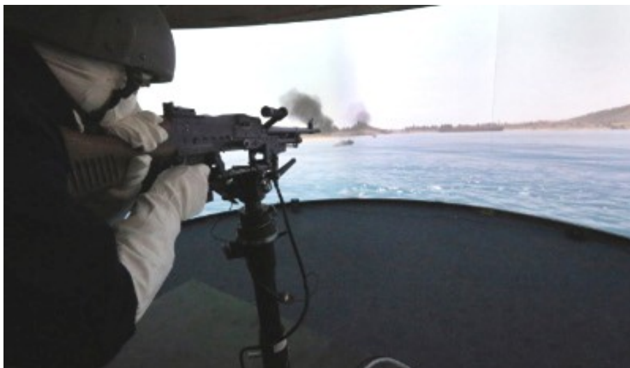
Rys. 7. Zamontowany na statku symulator karabinu maszynowego Fig. 7. Ship-mounted general-purpose machine gun simulator
