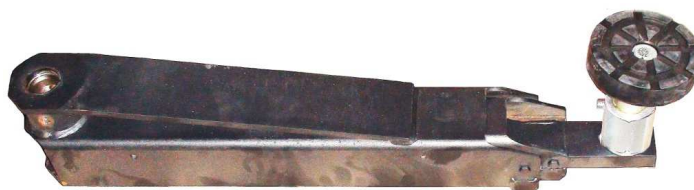
Rys. 4 Standardowe ramię montowane do zespołu podnoszącego podnośnika (fot. własna).
