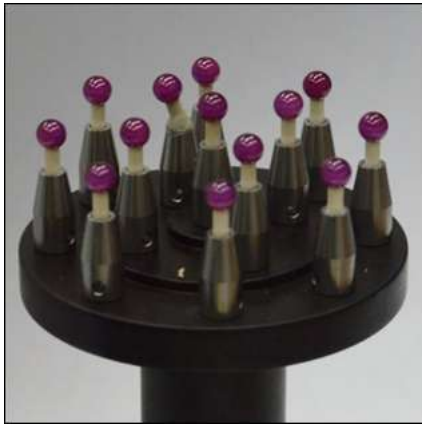
Rys. 7. Widok wzorca przestrzennego z elementami kulistymi Fig. 7. View of the spatial pattern with spherical elements
