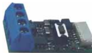
Rys. 6. Uniwersalny czujnik binarny
