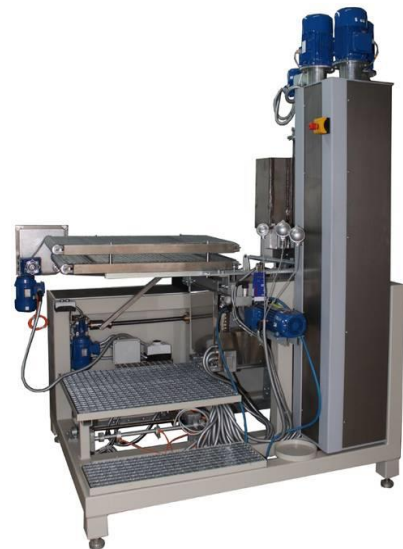
Rys. 7. Urządzenie do spieniania kompozytu w sposób ciągły: widok od strony zespołu odbioru piany
