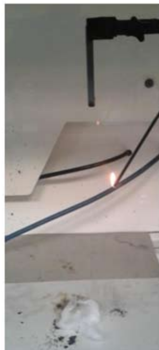
Rys. 2. Sposób palenia próbki T-27 MCS po dwukrotnym przetwórstwie Fig. 2. How to burn a T-27 MCS sample double processing
