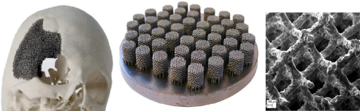
Rys. 1. (a) implant wykonany technologią SLM [8], (b) próby budowania implantu [9], (c) komórka elementarna[9]; SEM
