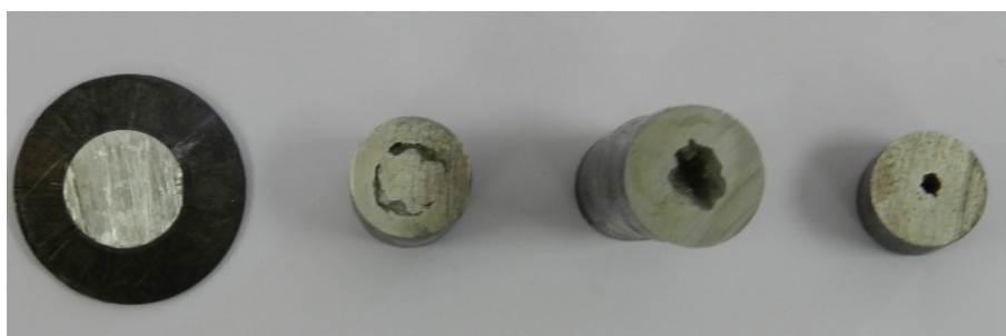
Rys. 5. Wady wewnętrzne prętów wyciśniętych z odkształceniem względnym \varepsilon = 75\% w temperaturze 280°C Fig. 5. Internal defects of bars extruded with relative strain of \varepsilon = 75\% at temperature of 280°C
