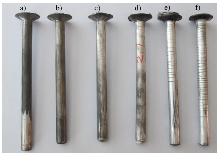
Rys. 8. Widok wyciśniętych próbek w zależności od temperatury procesu wyciskania: a) 280°C, b) 290°C, c i d) 300°C, e) 320°C, f) 340°C
