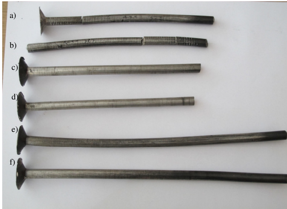
Rys. 3. Widok wyciśniętych próbek w zależności od temperatury procesu wyciskania: a, b) 335°C, c) 330°C, d) 320°C, e) 315°C, f) 305°C
