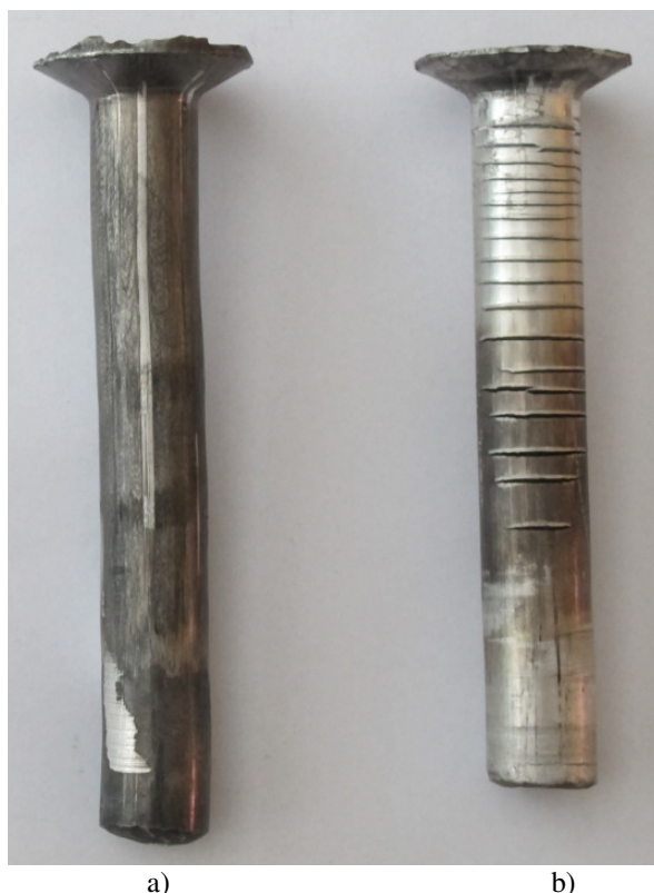
Rys. 4. Wynik wyciskania z odkształceniem względnym \varepsilon = 75\% w temperaturze: a) 280°C i b) 360°C Fig. 4. Result of extrusion with relative strain of \varepsilon = 75\% at temperature: a) 280°C and b) 360°C
