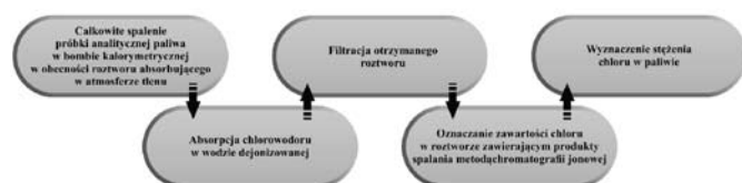
Rys. 2. Schemat postępowania podczas analiz z wykorzystaniem chromatografii jonowej
