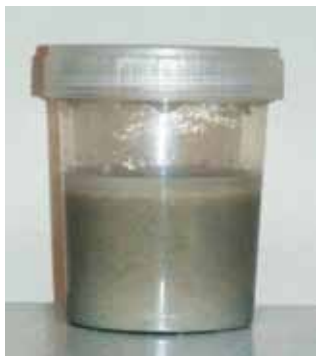
Rys. 3. Widok mieszaniny nieutwardzonego kleju na bazie uwodnionego krzemianu sodu sporządzonego w proporcji 1:1 z kwarcowym nośnikiem po 24 h od momentu sporządzenia
