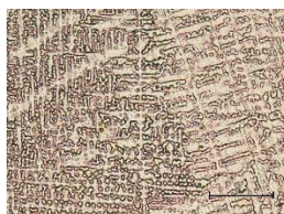
Rys. 1. Mikrostruktura stopu CuSn6, pow. 200x
