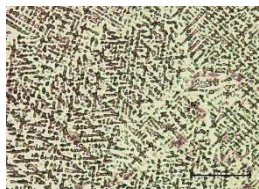
Rys. 13. Mikrostruktura stopu CuSn15Al0.1, pow. 200x
