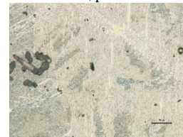
Rys. 10. Mikrostruktura stopu CuSn25, pow. 500x
