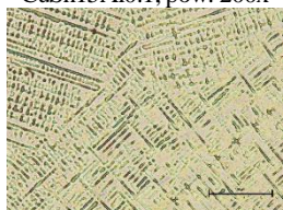
Rys. 15. Mikrostruktura stopu CuSn15Al2, pow. 200x
