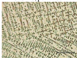
Rys. 5. Mikrostruktura stopu CuSn15, pow. 200x
