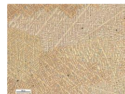
Rys. 18. Mikrostruktura stopu CuSn10Al1, pow. 100x
