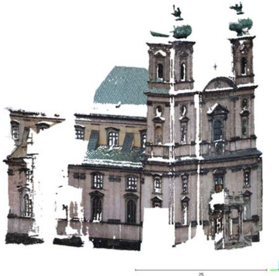
Ryc. 7. Chmura punktów ze zdjęć – model zewnętrzny
