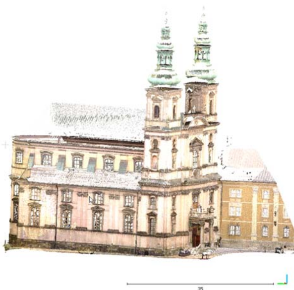
Ryc. 6. Chmura punktów Fig. 6. A cloud of points
