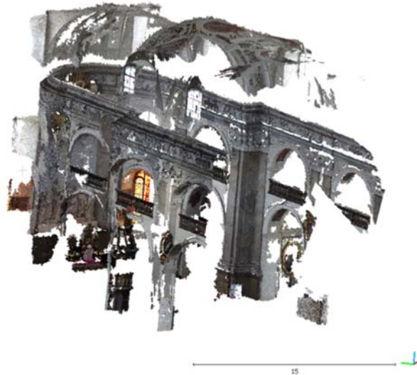
Ryc. 8. Chmura punktów ze zdjęć – model wewnętrzny
