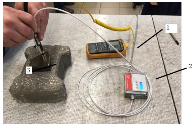
Rys. 3. Sposób ustalenia współczynnika emisyjności: 1-termometr stykowy TES-1312 z termoelementem TP-K03, 2-bezstykowy czujnik temperatury CTM-3SF22-C3, 3-wycinek badanej tarczy hamulcowej
